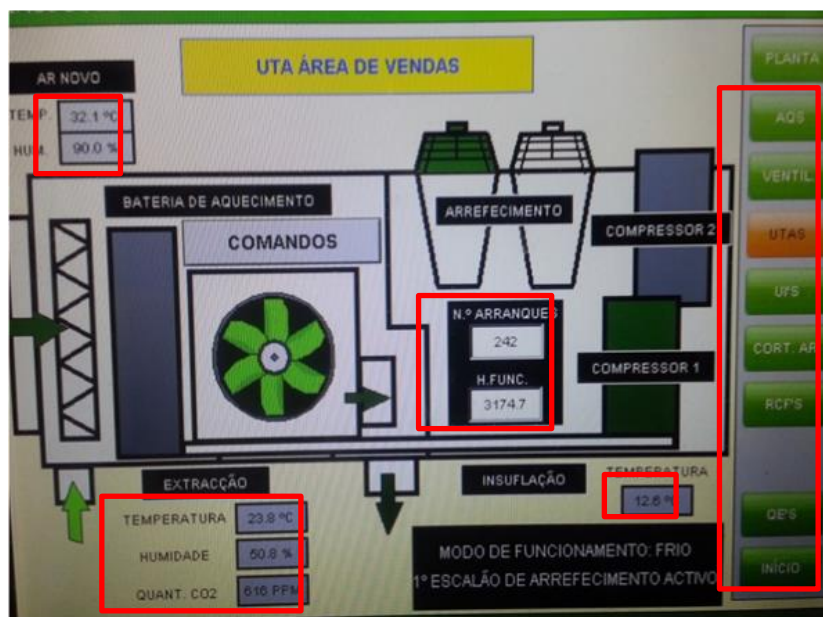
Figura 71 – Interface de um sistema de GTC.
